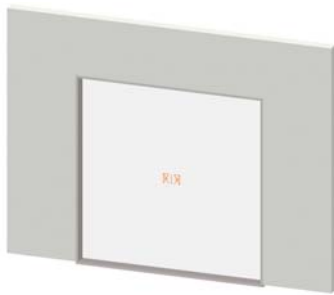
WW9 FIX 窓 幅 1,050 高さ 2,250 下端値 0
